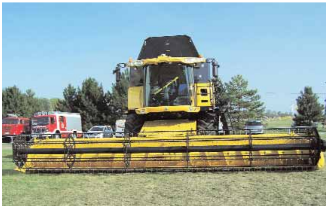
A világ legnagyobb kombájnja, amely elnyerte a kiállítás Nagydíját. Főbb adatai: NEW HOLLAND 9090 axiáldobos arató-cséplő gép, teljesítménye 591 LE, munkaszélessége 10,7 m, magtartály térfogata 12,5 m 3 , extrákkal (pl. GPS)
